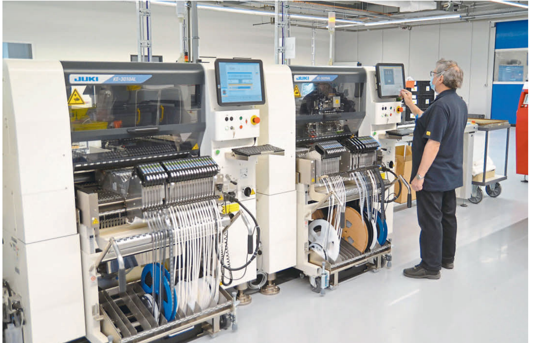
In der SMD-Abteilung im neuen Anbau werden Leiterplatten maschinell mit Denteils winzigen Bauteilen bestückt.
